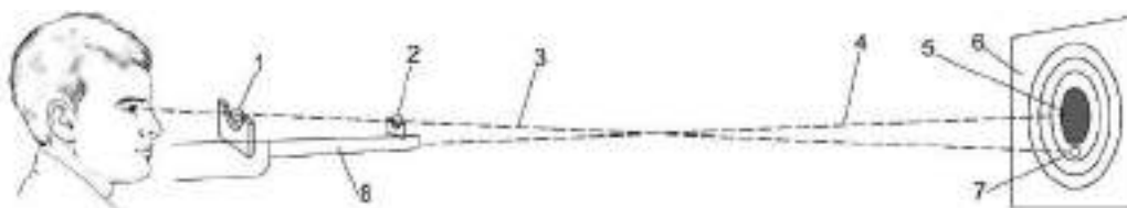
Іл. 2.8. Схема прицілювання в разі перевищення середньої точки прицілювання: 1 — середина прорізу прицілу; 2 — верхній край мушки; 3 — лінія прицілювання; 4 — середня траєкторія куль; 5 — середня точка влучення — центр мішені; 6 — мішень; 7 — точка прицілювання; 8 — ствол гвинтівки
