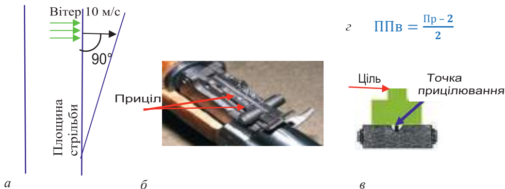
Іл. 1.9. Методика вибору абсолютного значення поправки (а) на бічний вітер під час прицілювання за допомогою прицільних пристроїв зброї (б, в) і формули (г)
