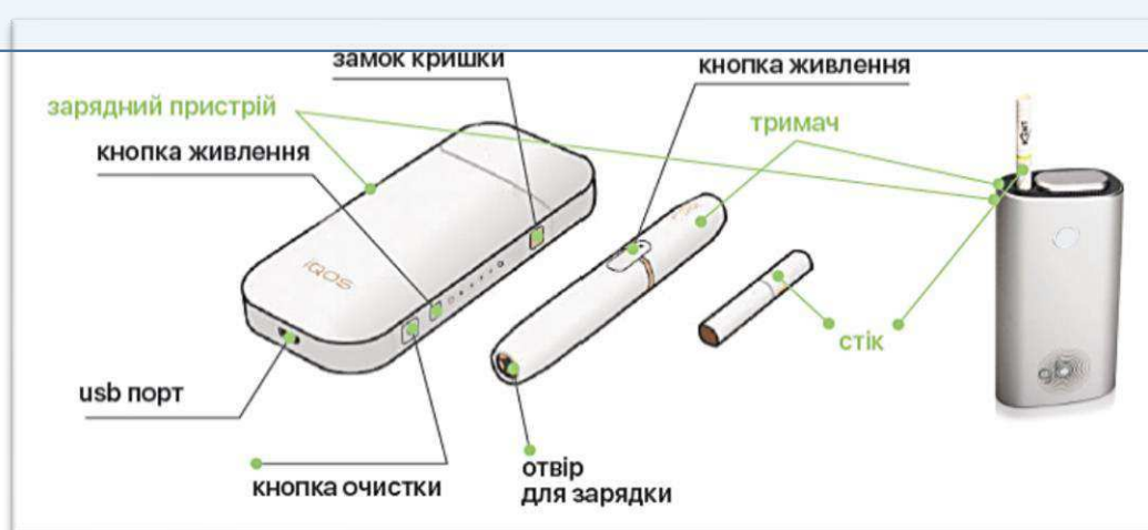
Рис. 2.1.3. Будова системи для нагрівання тютюну IQOS
